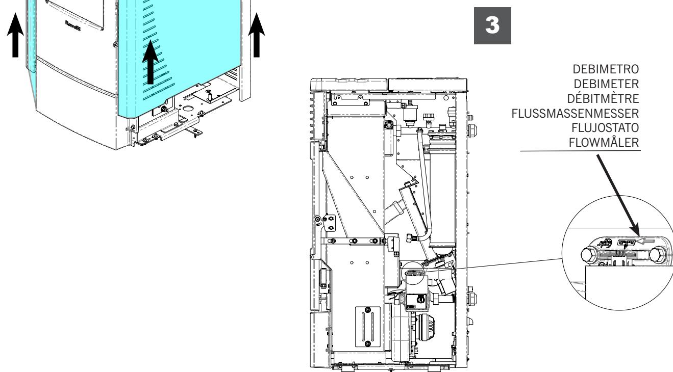
Come accedere alle botole di ispezione / How to access the inspection hatches / Comment accéder aux plaques d'inspection / So gelangen Sie an die Inspektionsklappen / Cómo acceder a las tapas de inspección / Hvordan der fås adgang til inspekionspladen
