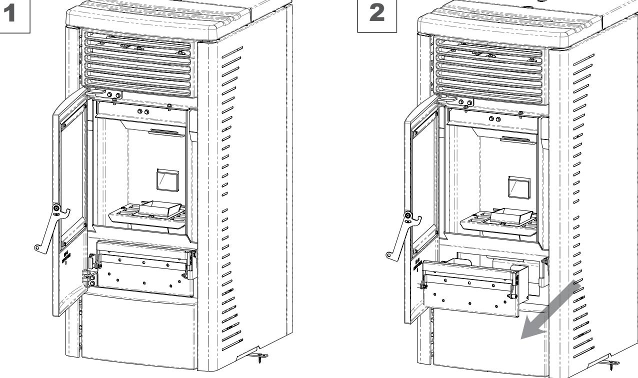
Come accedere al debimetro / How to access the debimeter / Comment accéder aux débitmètre / So gelangen Sie an die flussmassenmesser / Cómo acceder al FLUJOSTATO / Hvordan der fås a flowmaler
